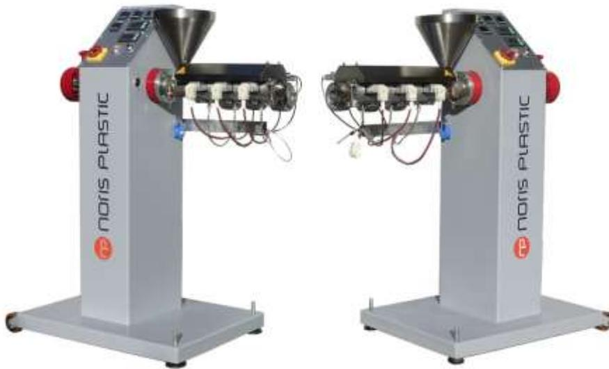
Der Extruder MINI ist aufgebaut in kompakter Bauweise, d.h. mit einem im Maschinenrahmen integrierten Schaltschrank und Bedienpult. Der Maschinenrahmen ist eine solide Schweißkonstruktion. Der Antrieb ist ein mit integriertem Frequenzumrichter ausgerüsteter AC- Motor mit Axiallagerung. Die Schnecke wird über einen Vielkeilwellenschaft angetrieben.
